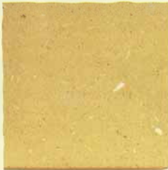
硬化遅延剤による仕上げ
